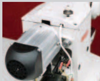
Il servo-motore molto potente e' flangiato sulla testa e ha un funzionamento silenzioso.
