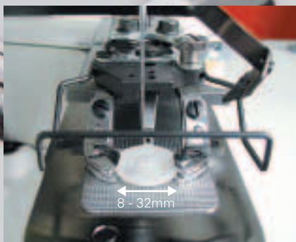
La 3371 puo' applicare bottoni con un diametro di 8 - 32 mm
